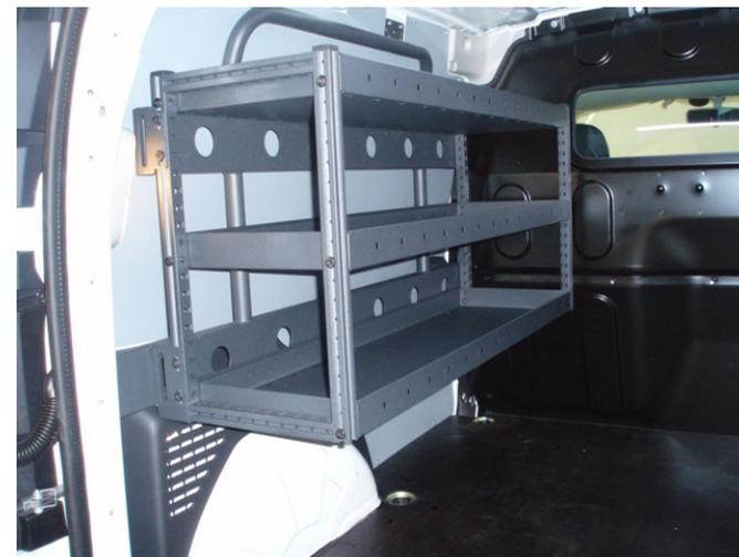
Автомобиль на базе Mercedes Citan оборудованный мебелью Modul-System используется для выездного сервиса в одной из Финских компаний. Используется подвисяная конструкция, преимущество использования такой конструкции в возможности использования всей поверхности пола для перевозки крупногабаритных или тяжелых грузов.
