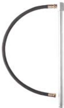
Узлы для перекачки масла для настенных коротких насосов. Включают всасывающую трубу Ø 42 с ножным клапаном, регулируемый по высоте переходник 2" и резиновый соединительный шланг 2 м x 3/4" (19 мм). Соединительная резьба 3/4" BSP (M).
