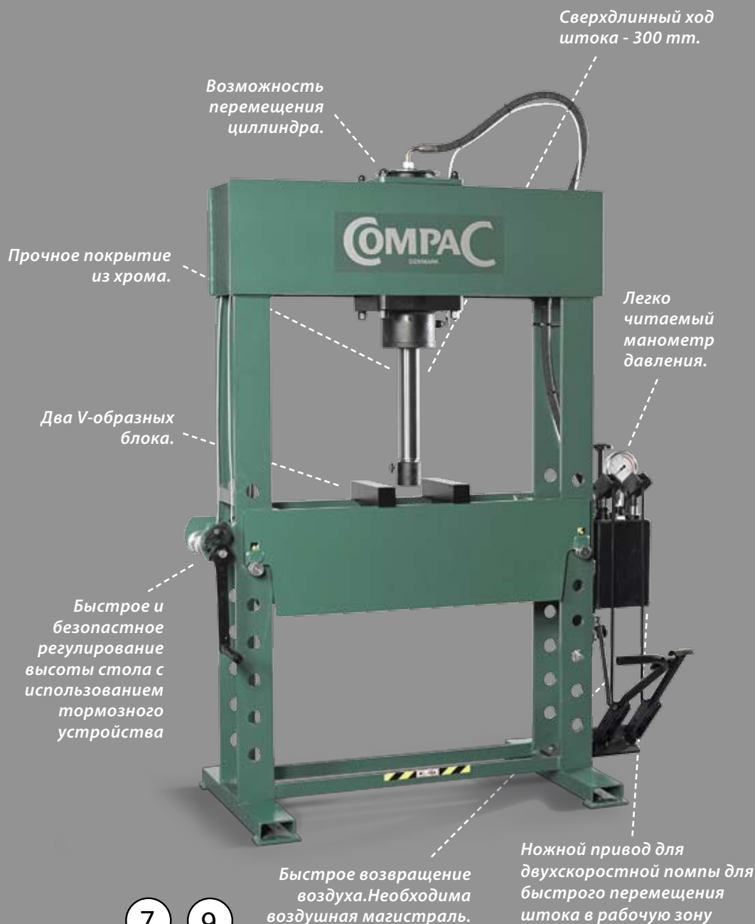
FP 40 FP 50 Педали управления освобождают обе руки оператора при работах под нагрузкой.
